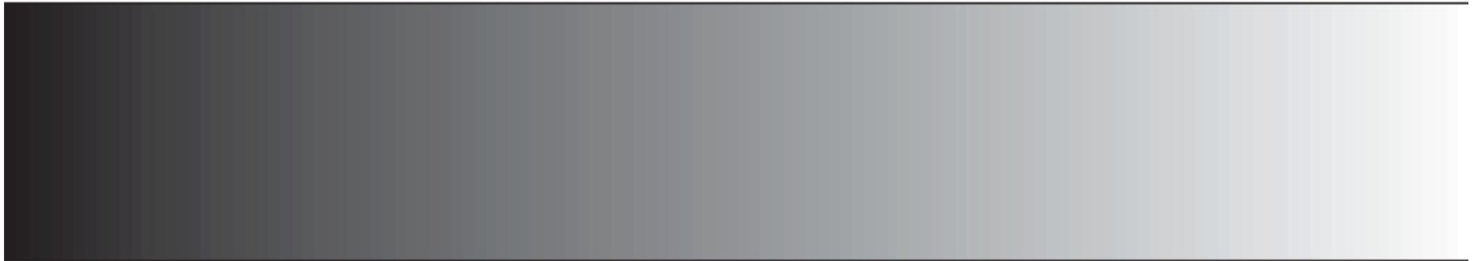
Quantização de tons de cinza com 256 intensidades (8 bits)
