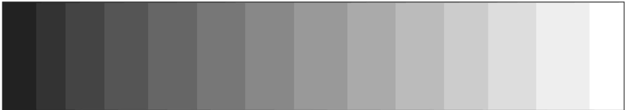
Quantização de tons de cinza com 16 intensidades (4 bits)
