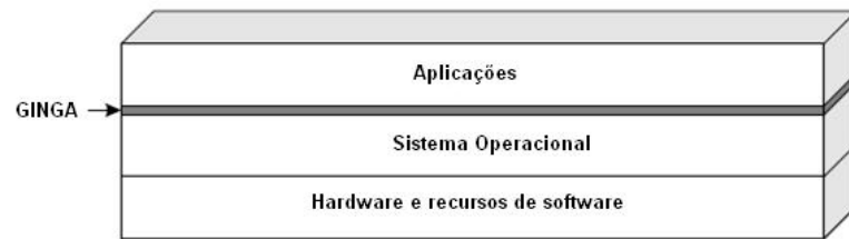
Figura 4.8: Arquitetura de um Sistema Típico de TV Digital com Set-Top Box.
