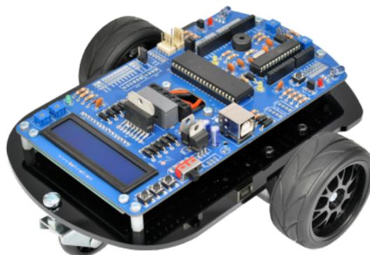
Figura 1.14: Robo que utiliza motor CC para se mover
