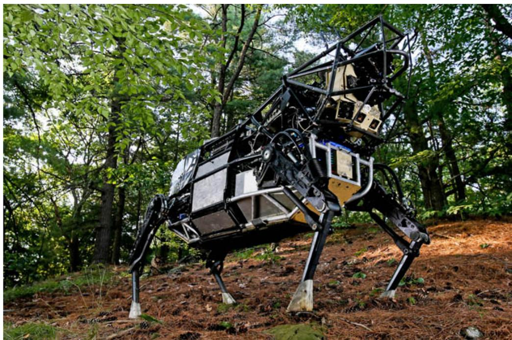
Figura 4: Robô militar LS3, desenvolvido pela empresa Boston Dynamics para auxiliar em operações táticas transportando suprimento em terrenos acidentados
