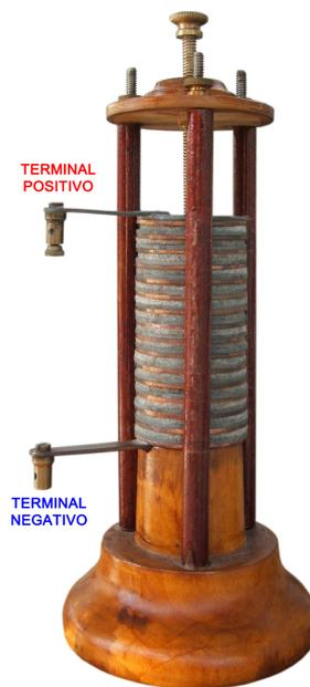
Figura 1.20: Primeira bateria criada por Alessandro Volta
