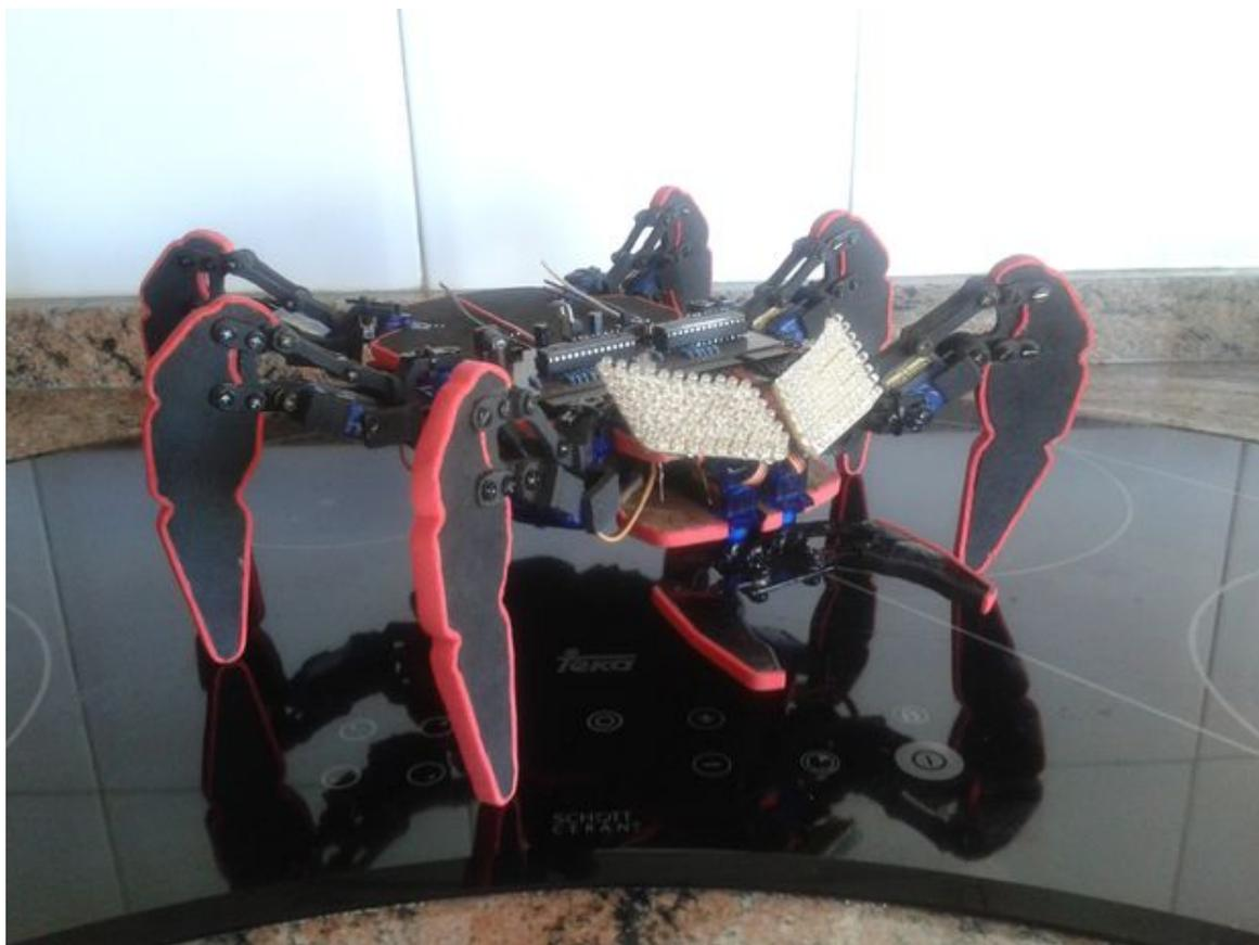
Figura 1.16: Robô haxapod controlado por *Arduino*
