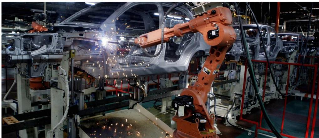
Figura 2: Soldagem Robotizada
