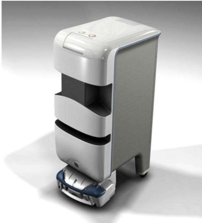
Figura 3: Robô TUG, utilizado para transportar diversos materiais em hospitais
